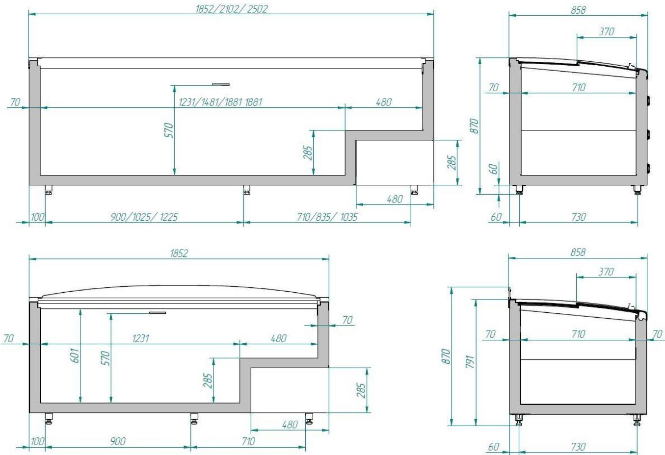
В низкотемпературном режиме он предназначен для демонстрации, продажи и хранения предварительно замороженных пищевых продуктов при температуре от -24°C до -18°C, в средне-низкотемпературном режиме он предназначен для демонстрации, продажи и хранения предварительно охлажденных пищевых продуктов при температуре от +2°C до +6°C. При температуре окружающей среды до +30°C и влажности не более 60% ларь наилучшим образом обеспечивает хранение предварительно замороженных или охлажденных продуктов.
